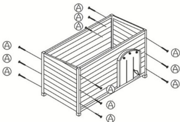
**1. Fije los paneles laterales a los paneles frontal y posterior con 12 pernos y tuercas (A)**
