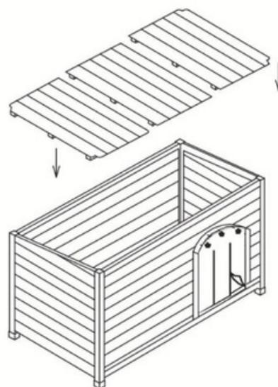
**2. Coloque los paneles del piso dentro**
