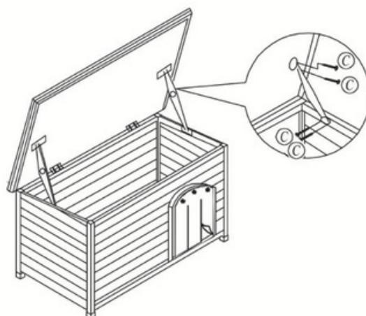
**4. Fije las bisagras x2 usando tornillos (C) x 8 Terminado**
